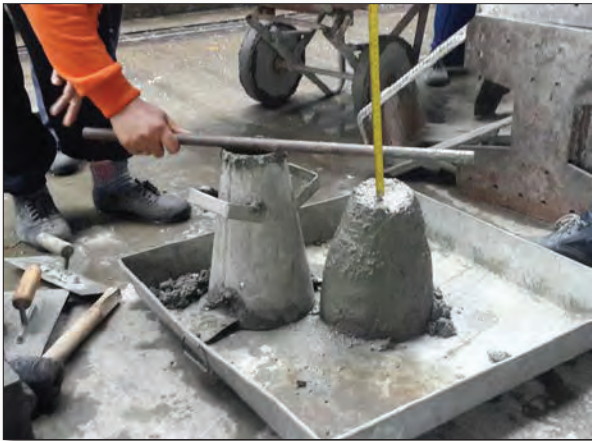
ภาพแสดงการตรวจสอบความชื้นเหลวของคอนกรีต (Slump) และการเทคอนกรีตเสาเข็ม
