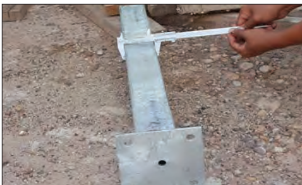
ภาพถ่ายแสดงเสาราวกันตกที่ทำการติดตั้งเสาและแผ่นเหล็กรองรับและทำการชุบสังกะสีมาแล้ว
