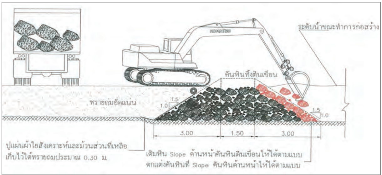
ภาพแสดงการปูวัสดุรองในร่องคันหินและทำการทิ้งที่ Slope ด้านหน้าคันหินให้ได้ตามรูปแบบ
