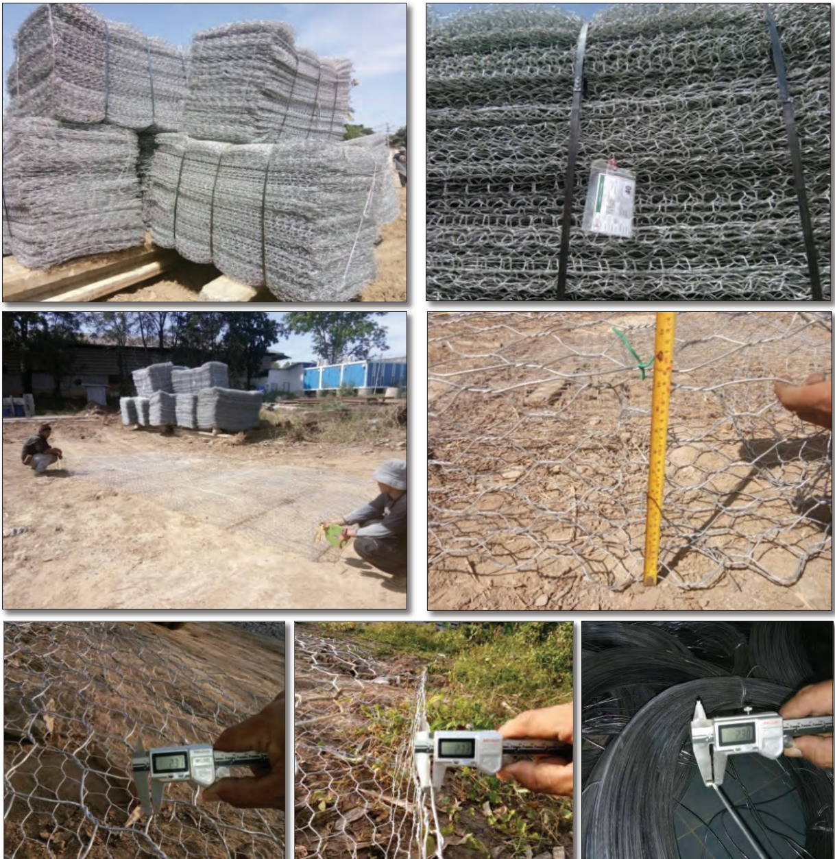
ภาพแสดงการตรวจสอบขนาดกล่องลวดตาข่าย และวัดขนาดเส้นผ่านศูนย์กลางลวดกล่อง
